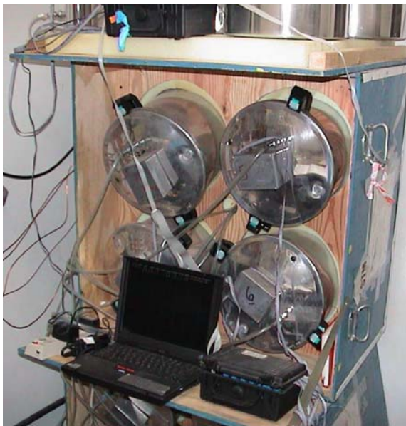
Figura 14 - Torre vertical-65m (A); Sistema de medição da atividade de ^{222}\text{Rn} do dossel (B), Sistema de medição da concentração de metano por cromatografia gasosa (C) 33
