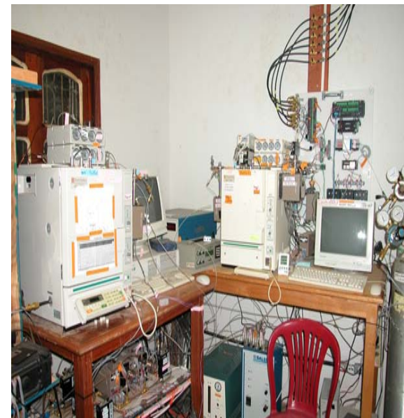
Figura 14 - Torre vertical-65m (A); Sistema de medição da atividade de ^{222}\text{Rn} do dossel (B), Sistema de medição da concentração de metano por cromatografia gasosa (C) 33
