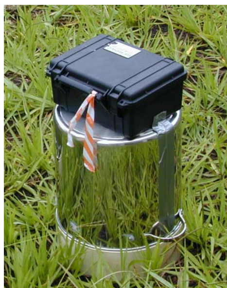
Figura 12 – Diferentes tipos de detectores de ^{222}\text{Rn} utilizados para medições feitas nos perfis verticais das torres e de fluxo do solo
