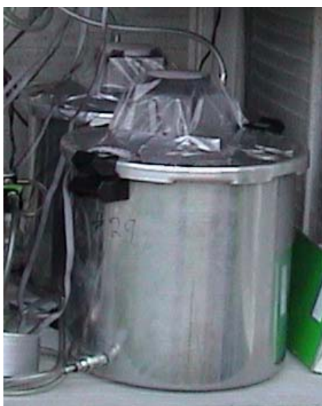
Figura 12 – Diferentes tipos de detectores de ^{222}\text{Rn} utilizados para medições feitas nos perfis verticais das torres e de fluxo do solo
