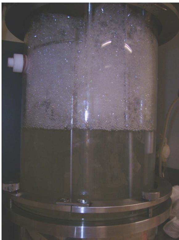
FIGURA 7 – FERMENTAÇÃO SUBMERSA EM BIORREATOR
