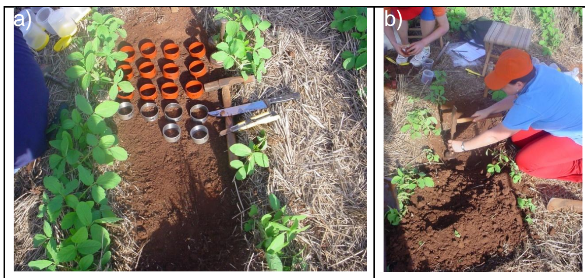
Figura 3 -a) cilindros utilizados na coleta de solos na área experimental; b) coleta à campo das amostras de solo.
