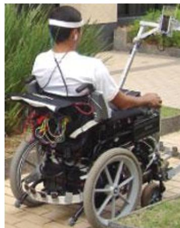
Movida pela ‘imaginação motora’, a cadeira tem acoplado um sistema que capta as ondas geradas pela intenção do movimento das mãos de pessoas com deficiência (foto: Teodiano Freire Bastos).
