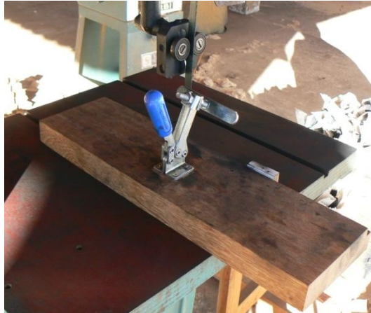
FIGURA 5 Aparato de segurança de serra de fita para corte de peças de pequenas dimensões.
