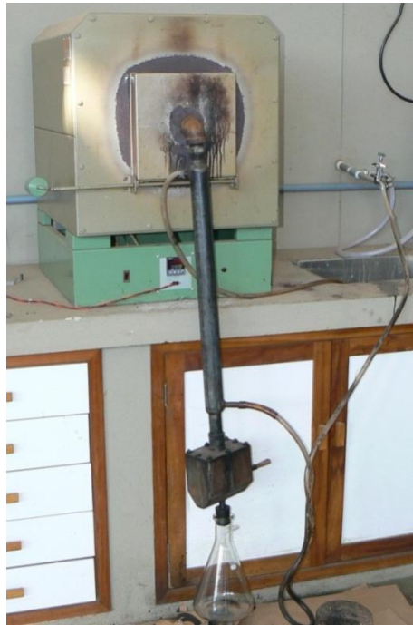
FIGURA 4 Forno elétrico adaptado para a realização de carbonização.
