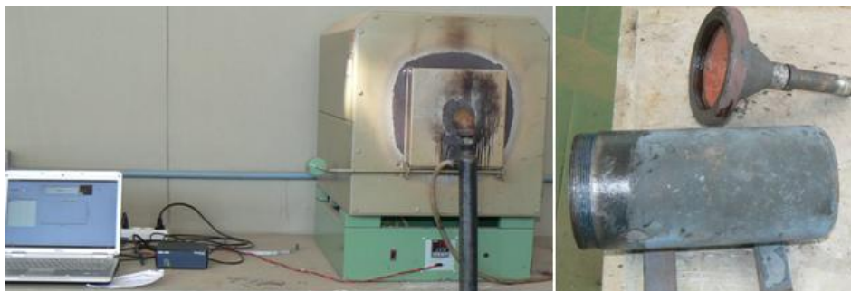
FIGURA 6 Aparato para carbonização informatizado e reator de carbonização.
