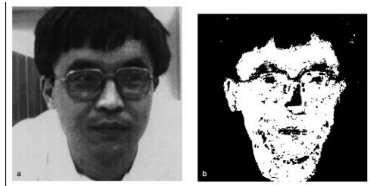
Figura 10 - (a) imagem original e (b) resultado da segmentação da cor da pele na imagem original (WANG e SUNG, 1999)
