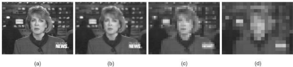
Figura 1 - Imagem em várias resoluções. (a) imagem original n=1 . (b) n=4 . (c) n=8 . (d) n=16
