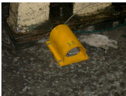
Figura 19 – Exemplos de pedais com proteção contra acionamentos acidentais
