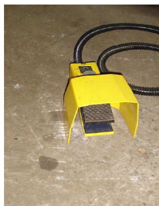
Figura 19 – Exemplos de pedais com proteção contra acionamentos acidentais
