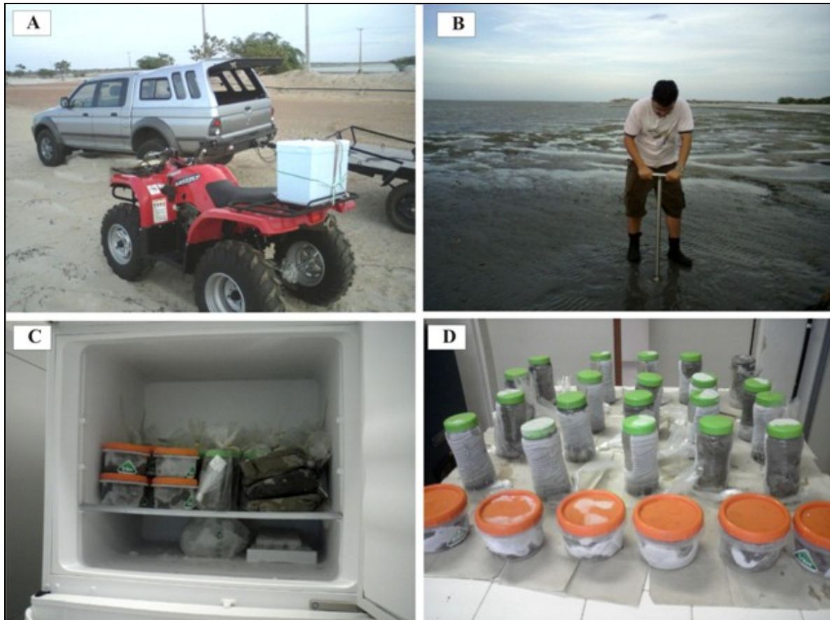
Figura 3.4: (A) Quadriciclo que deu apoio para o deslocamento em campo; (B) trado de aço inox; (C) amostras armazenadas em freezer a 4°C; (D) chegada ao laboratório para realização do pré-tratamento.
