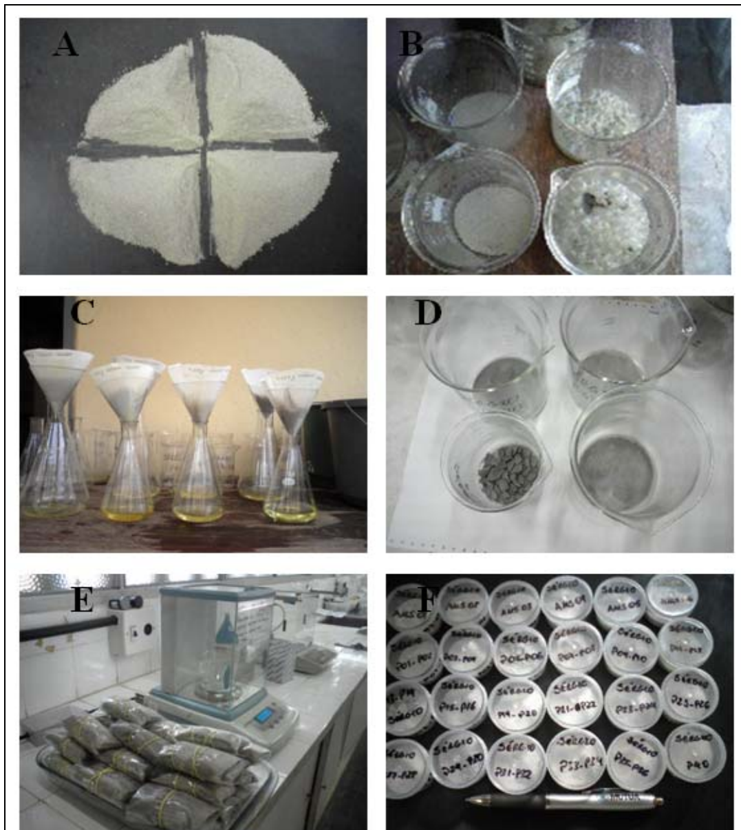
Figura 3.10: Metodologia adotada para extração de carbonatos e matéria orgânica. A: quartejamento; B: reação do ácido clorídrico; C: filtragem; D: Amostras secas; E: Balança digital e F: Armazenamento antes das análises granulométricas.
