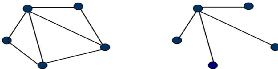
Figura 6. Topologia Lógica - Topologia Física. (em geral usa-se menos conexões físicas, por questão de custo, mas isso não impede a conexão lógica)
