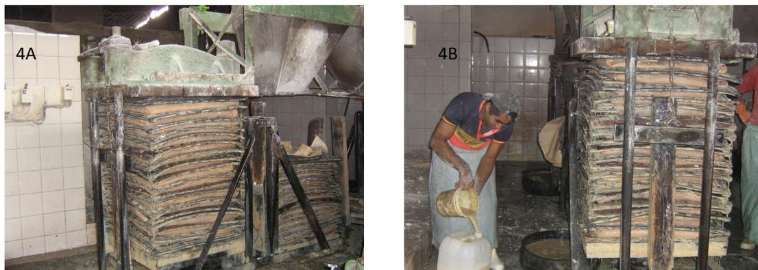
**Figura 4** – Prensagem da mandioca e coleta da água de manipueira (A = prensagem; B = coleta).
