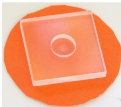
**Figura 1.4.** Modelo de alimentador de acrílico usado dentro da Caixa de Teste para Teste de Tomada de Decisão. Dimensões: 3,0 x 3,0 x 0,5 cm<sup>3</sup>, com um orifício central, onde se coloca a solução de sacarose de 0,5 cm de diâmetro e 0,3 cm de profundidade.
