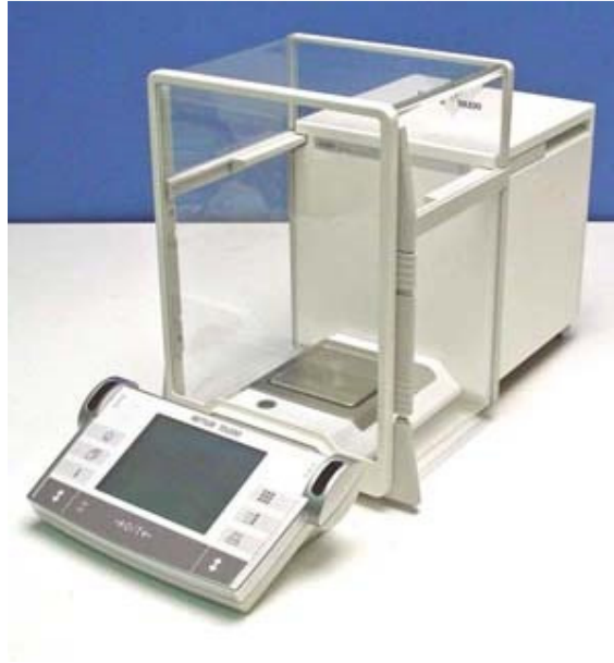
Figura 3.6. Balança utilizada para o cálculo da massa específica das amostras sinterizadas.
