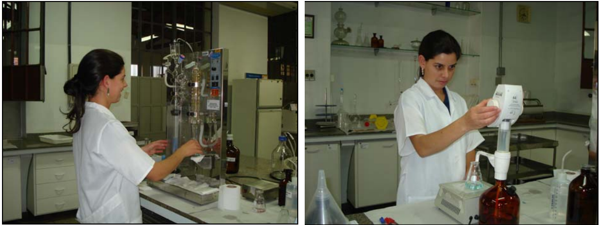
Figura 12 – Determinação de N total pelo método Kjeldahl
