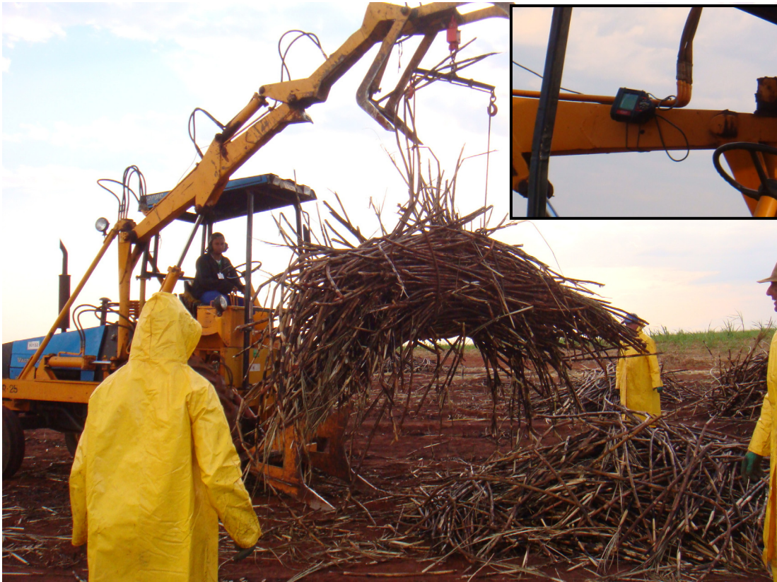
Figura 6 – Pesagem das parcelas. Em detalhe, visor digital da balança no braço da carregadeira. Fazenda Alvorada, Usina Rio Vermelho. Junqueirópolis – SP, 2009
