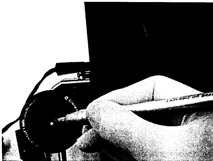
Figura 7 – Aferição da potencia com auxilio do medidor de potencia
