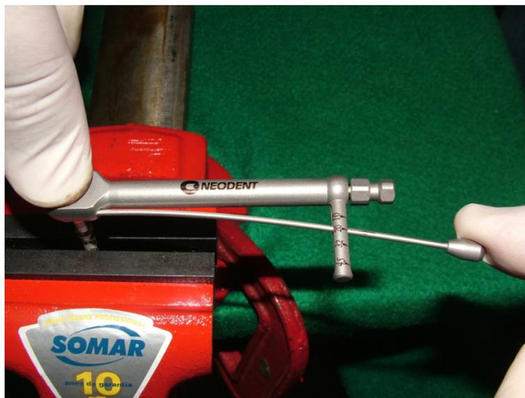
Figura 3. Aplicação do torque recomendado pelo fabricante.
