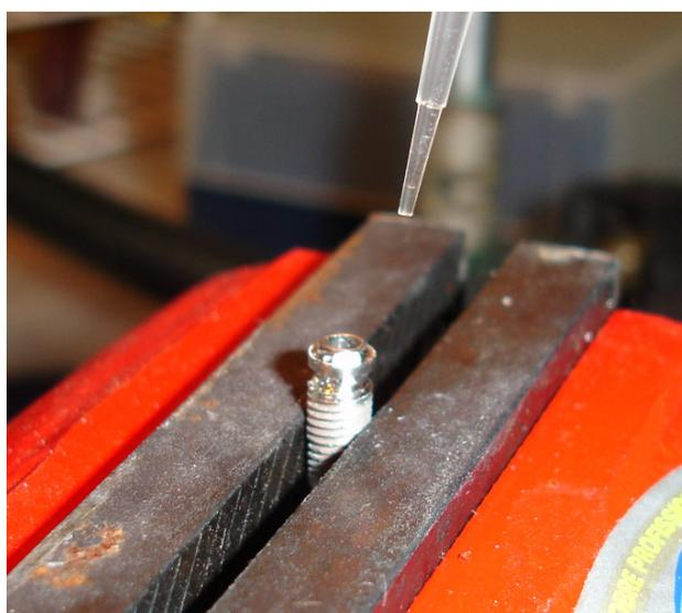
Figura 1. Suspensão de *Escherichia coli* sendo inoculada no implante.
