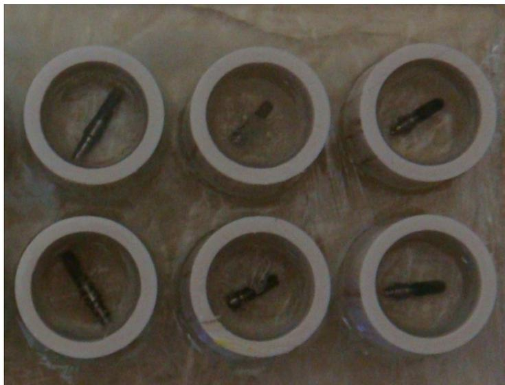
Figura 4. Conjunto implante-pilar recém-imersos na base de resina epóxi.
