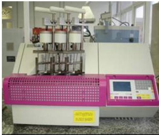
Figura 30: Equipamento CEAST utilizado nos ensaios de Vicat e HDT
