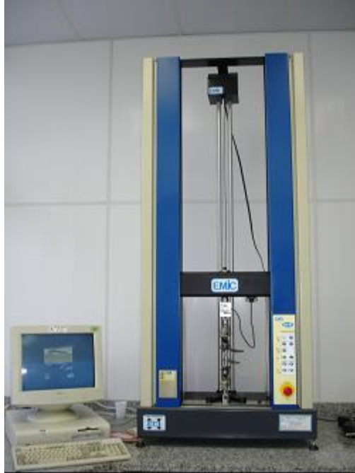
Figura 28: Equipamento para ensaios de Tração-Deformação (EMIC)
