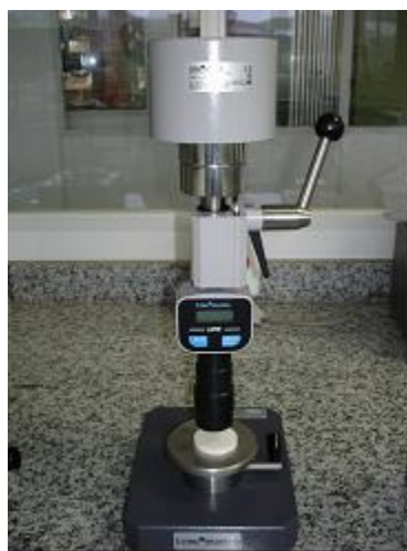
Figura 29: Durômetro utilizado nos ensaios de Dureza Shore D
