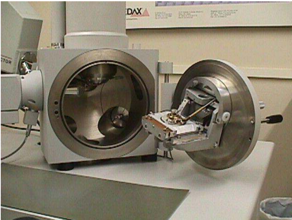
Fig 10. O aparelho de EDX utilizado na análise das amostras
