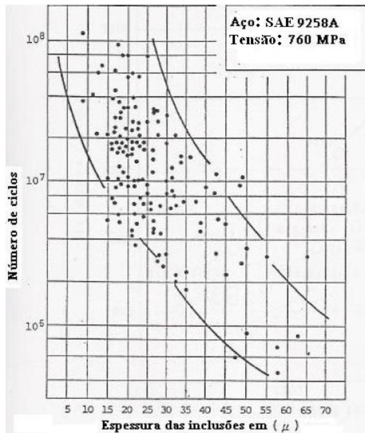
Figura 2.10 – Influência da espessura das inclusões no número de ciclos em um ensaio de fadiga (Nakamura), utilizando tensão de 760 MPa (KAWAHARA, 2000)
