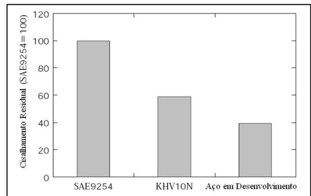
Figura 2.3 – Resistência à fadiga de aços para molas de válvulas (SUDA, 2007).
