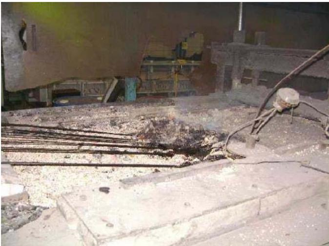
Figura 3.7 – Entrada dos arames no tanque de chumbo líquido, onde ocorre o revenimento. (cortesia GERDAU AEB, 2008).
