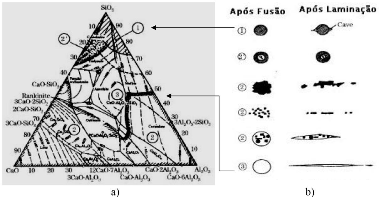
Figura 2.12 – a) Diagrama ternário CaO – Al<sub>2</sub>O<sub>3</sub> – SiO<sub>2</sub>, mostrando as regiões das inclusões com suas morfologias; b) Morfologia das inclusões não metálicas após fusão e laminação, referenciadas por sua região no diagrama ternário (LEANDRO, 2006)
