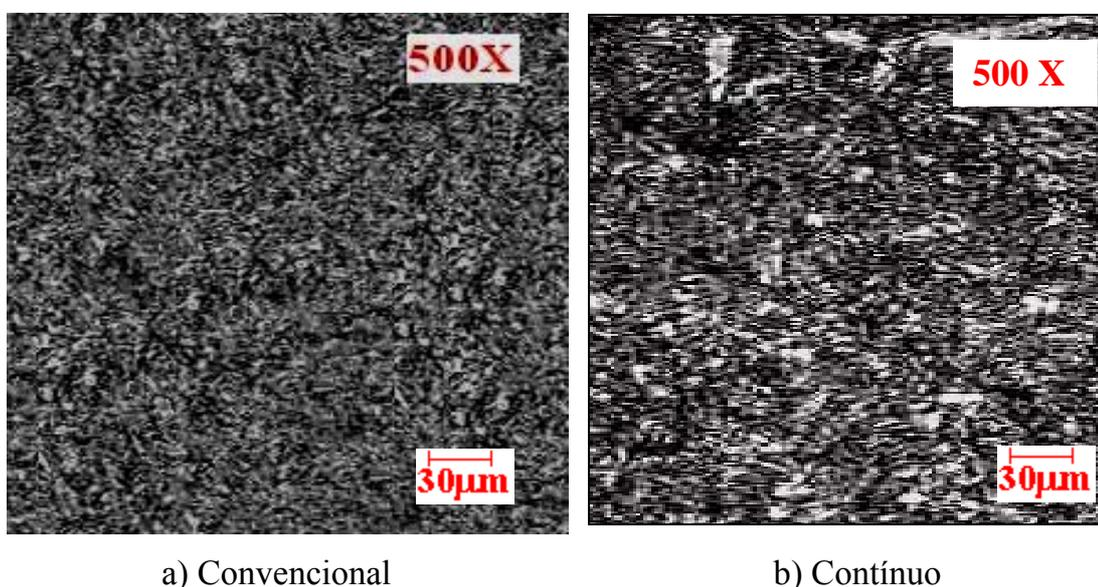
Figura 4.1 – Metalografia realizada em amostras do arame para molas: a) produzido por lingotamento convencional e b) produzido por lingotamento contínuo, mostrando o aspecto da martensita revenida em ambos os casos. Ataque: Nital 2%.
