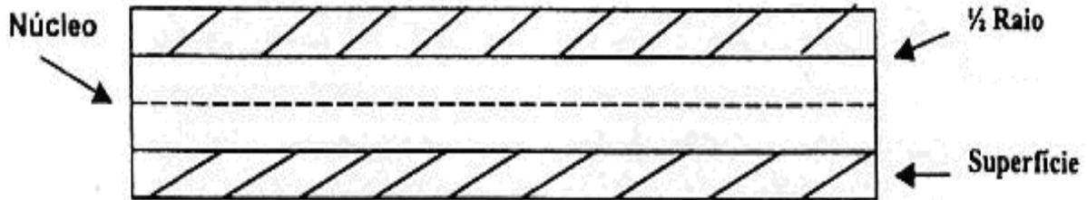
Figura 3.8 – Superfície e núcleo da amostra utilizada para análise de inclusões pelo método Max-T. Corte longitudinal da amostra com 25 mm. (cortesia, GERDAU AEB).
