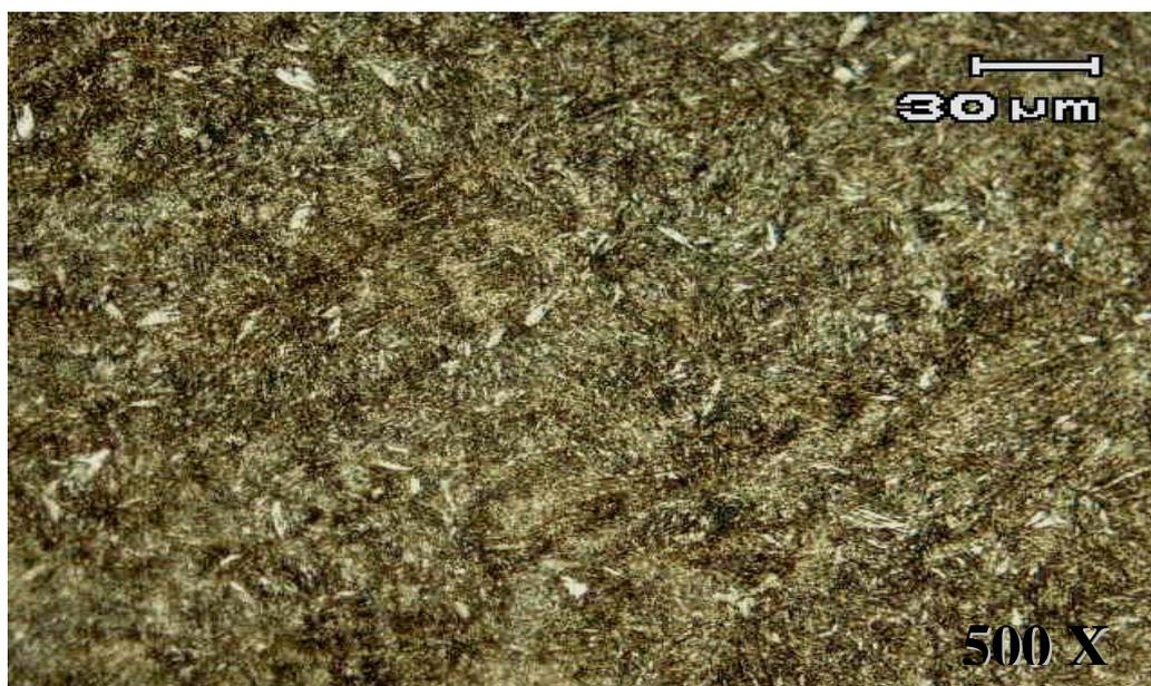
Figura 4.3 – Metalografia realizada em amostra da barra utilizada na confecção dos corpos-de-prova, produzida por lingotamento contínuo, mostrando o aspecto da martensita revenida. Ataque: Nital 2%.
