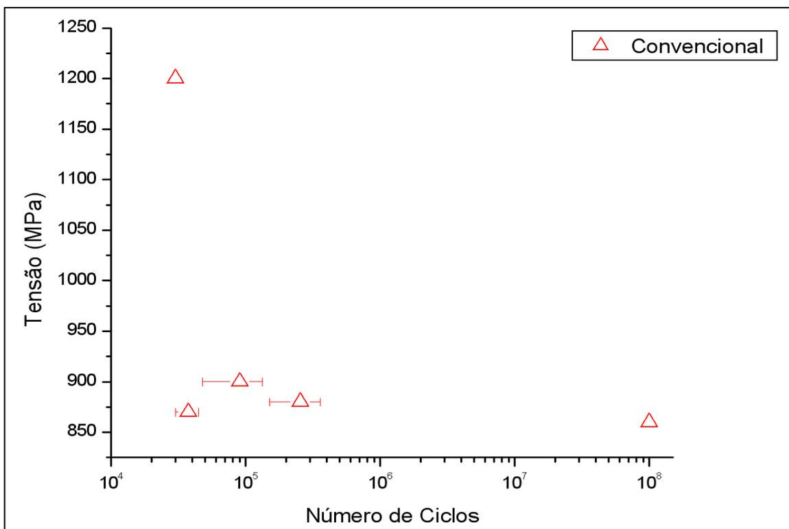
Figura 4.6 – Curva S-logN para o arame produzido por lingotamento convencional.
