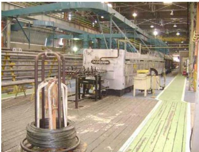
Figura 3.5 – Área de desbobinamento do arame trefilado para o tratamento térmico, e ao fundo, forno de têmpera e revenimento (cortesia, GERDAU AEB, 2008).
