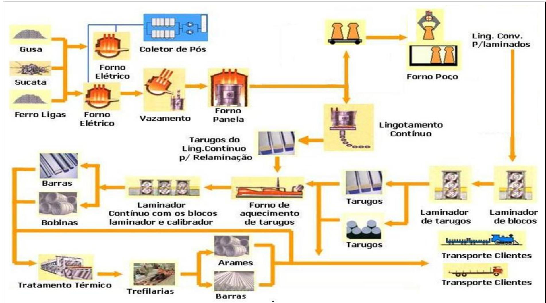
Figura 2.7 – Esquema ilustrativo do ciclo de produção de barras trefiladas e de arames para molas de válvulas de motores (cortesia, GERDAU AEB, 2008).
