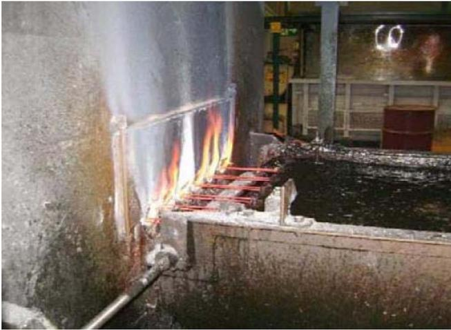
Figura 3.6 – Saída dos arames austenitizados do forno e sua imersão no tanque com polímero, para o tratamento de têmpera. (cortesia GERDAU AEB, 2008).
