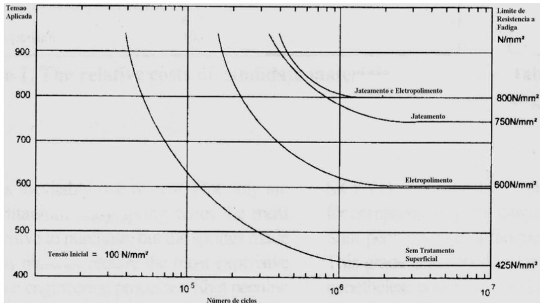
Figura 2.36 – Curvas S-N para um aço inox 302 utilizado para molas com diversos tipos de acabamento superficial (HAYES, 2006).
