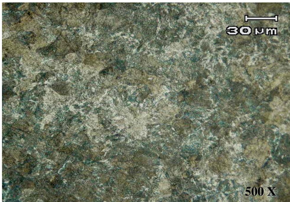
Figura 4.4 – Metalografia de amostra do corpo-de-prova da rota de lingotamento contínuo (sem tratamento térmico). Ataque: Nital 2%.
