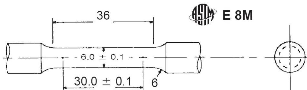
Figura 3.16 – Dimensões (em mm) dos corpos-de-prova utilizados no ensaio de tração. (ASTM E 8M).
