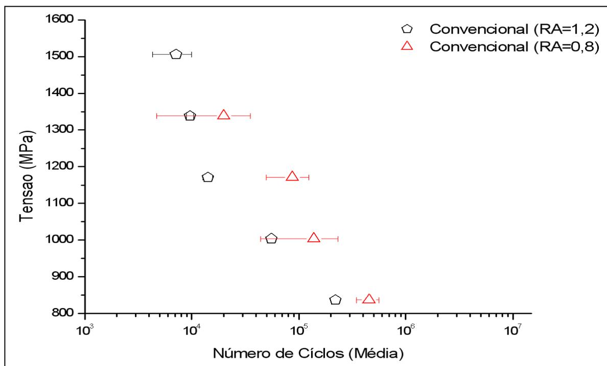
Figura 4.14 – Curvas S-logN mostrando o efeito da rugosidade superficial no comportamento em fadiga axial para corpos-de-prova obtidos de fio-máquina produzido por lingotamento convencional.
