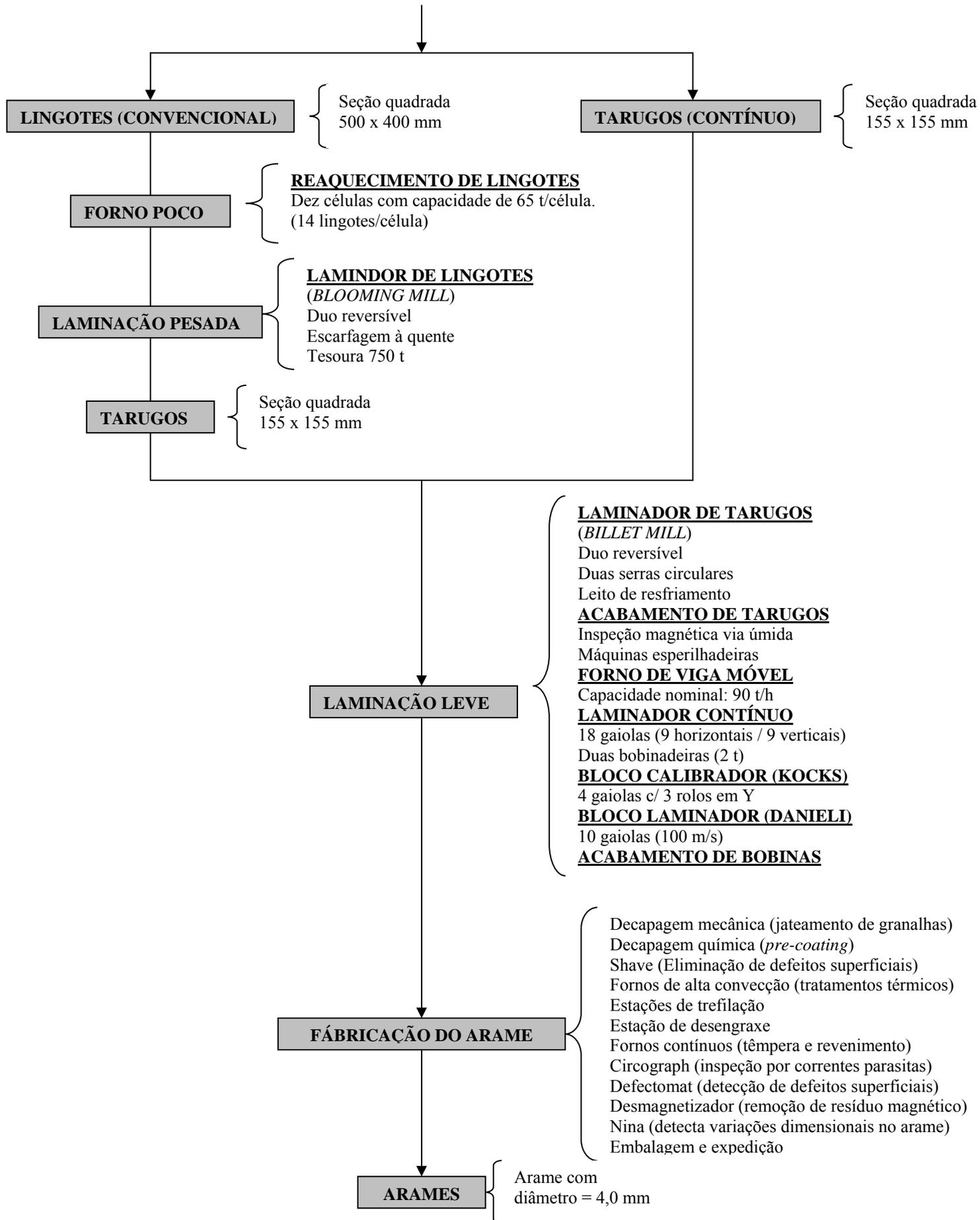
Figura 2.6 – Fluxograma do processo de fabricação de arames para molas de válvulas.
