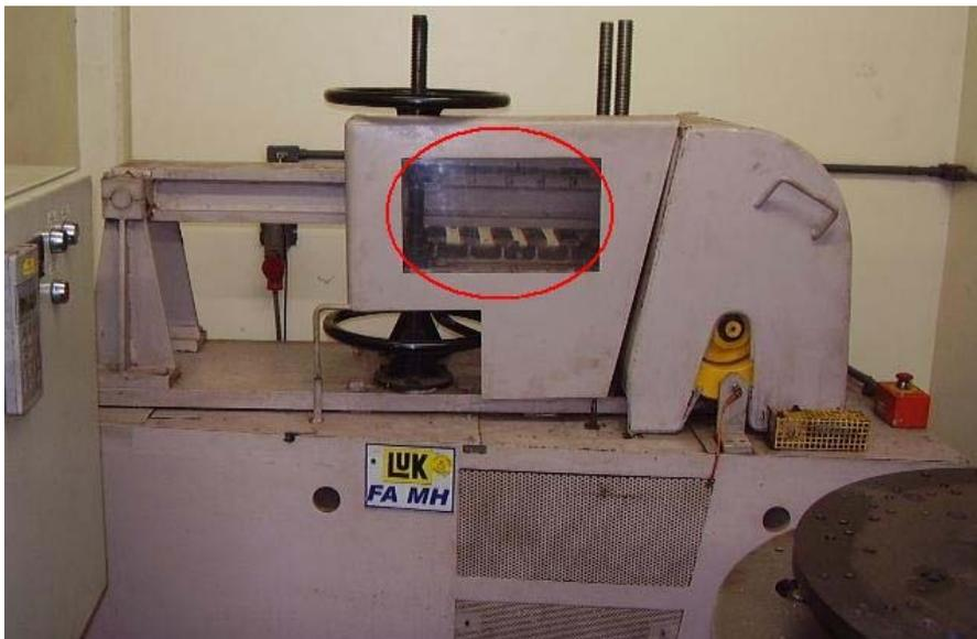
Figura 3.12 – Máquina para ensaios de fadiga em molas de válvulas (cortesia, LUK).
