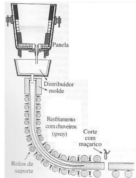
Figura 3.4 – Processo de lingotamento contínuo (rota experimental para produção de aços para molas de válvulas (RIZZO, 2005).
