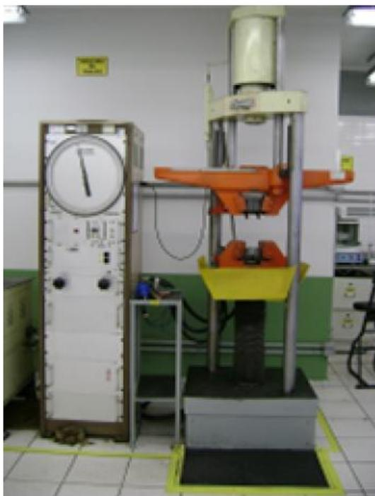
Figura 3.17 – Máquina para ensaio de tração em arames (cortesia, GERDAU AEB, 2008).
