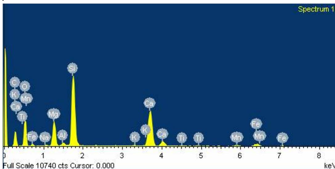
Figura 4.27 – Resultado do EDS realizado na inclusão da figura 4.26.
