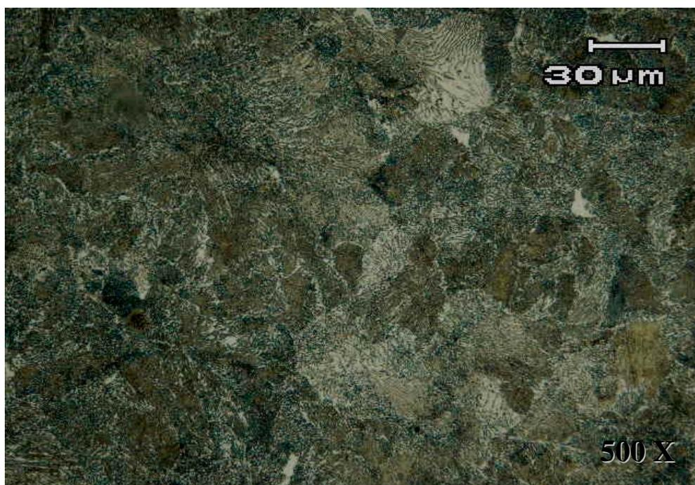
Figura 4.5 – Metalografia de amostra do corpo-de-prova da rota de lingotamento convencional (sem tratamento térmico). Ataque: Nital 2%.
