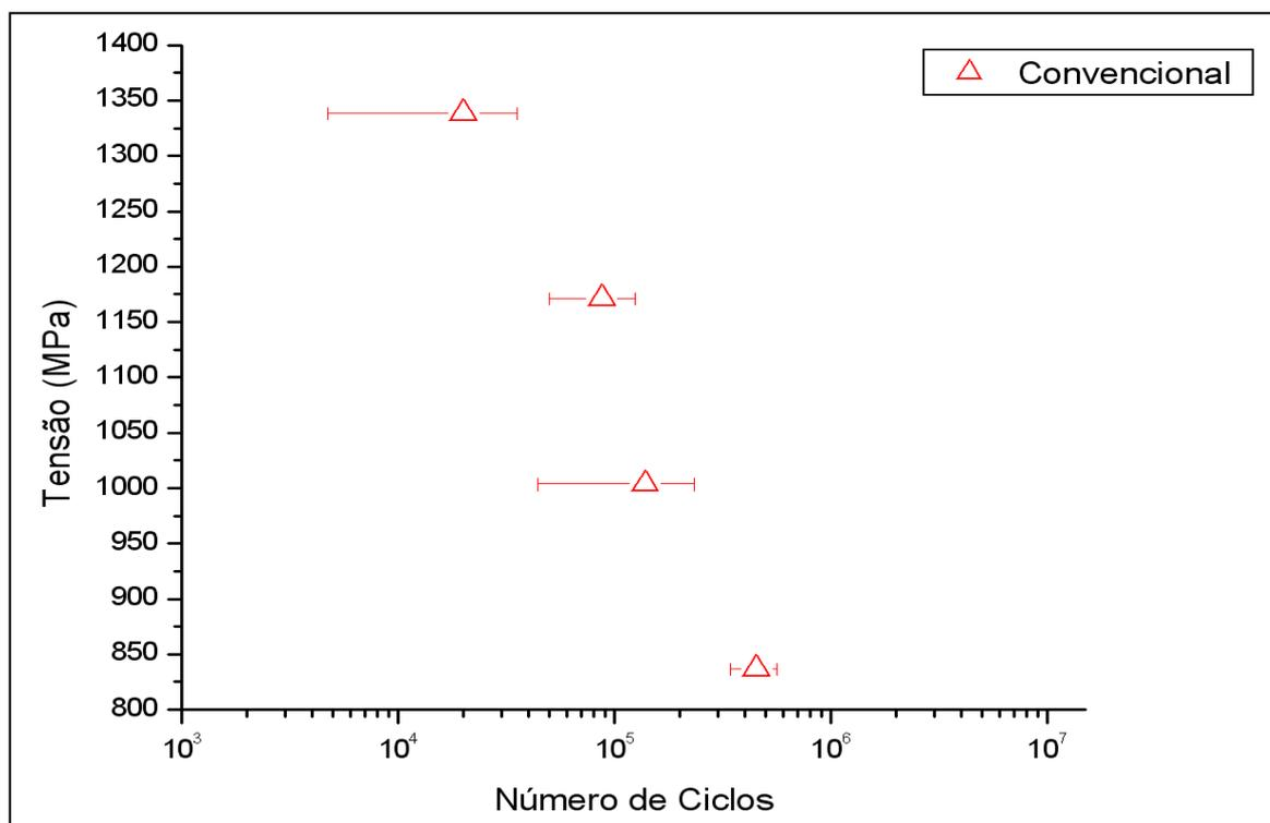
Figura 4.10 – Curva S-logN referente aos ensaios de fadiga axial realizados em corpos-de-prova obtidos de fio-máquina produzido por lingotamento convencional.
