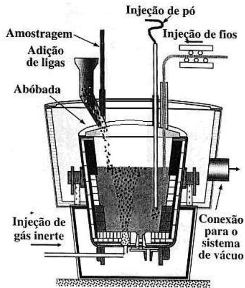
Figura 3.2 – Representação esquemática de uma estação de refino secundário (estação de vácuo). Após este estágio, o metal líquido é transferido para a estação de aquecimento por eletrodos de grafite (RIZZO, 2005).
