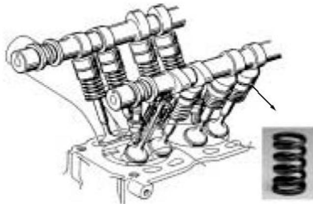
Figura 1.1– Disposição das molas de válvulas em um motor de automóvel (SUDA, 2005)
