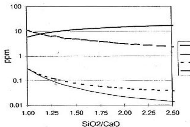
Figura 2.23 – Efeito da basicidade da escória no Al, Ca, Mg e O<sub>2</sub> em equilíbrio com o aço (AUCLAIR, 1998).
