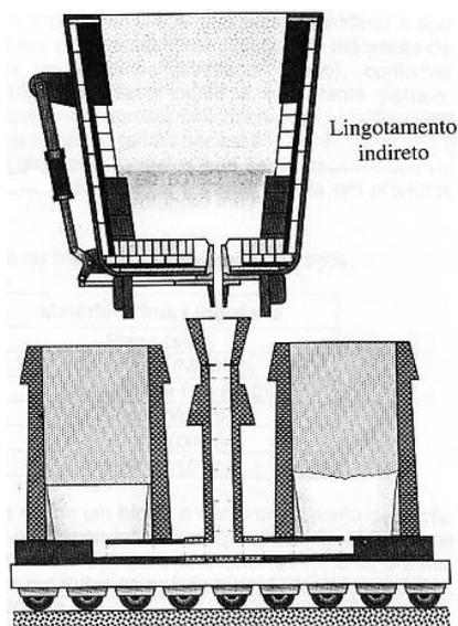
Figura 3.3 – Processo de lingotamento convencional indireto, utilizado para se produzir aços para molas de válvulas (RIZZO, 2005).
