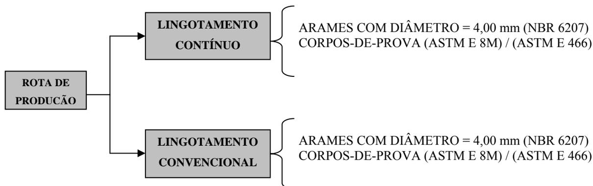
Figura 3.14 – Fluxograma mostrando a origem dos corpos-de-prova de tração e fadiga
