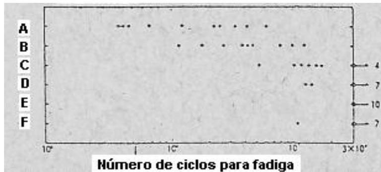
Figura 2.29 – Relação entre composição das inclusões não metálicas e as propriedades de fadiga (OHSHIRO, 1987).
