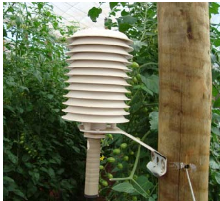
Figura 13 – Abrigo multiplacas com sensor para a medição da temperatura ( T ) e da umidade relativa (UR) do ar, instalado a 2 m de altura, em cada um dos ambientes protegidos
