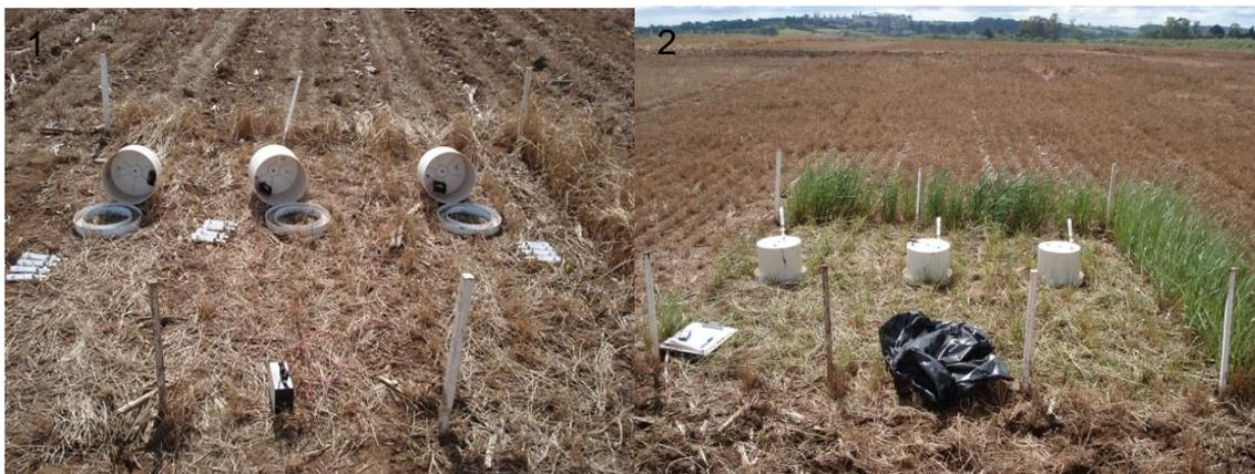
**Fotos 1 e 2.** Vista geral do conjunto das três câmaras de coleta de GEE, ligadas a bateria portátil. A base de metal contém uma calha com água, para vedação do sistema. Seringas de coleta são acopladas no topo da câmara. Na parte inferior a um ventilador acoplado para homogeneizar o ar durante a coleta.
