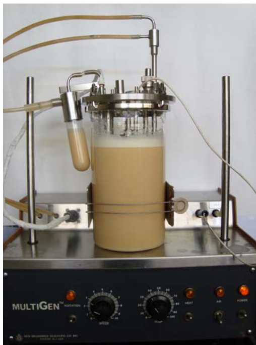
Figura 3.1 – Foto do reator da marca New Brunswick, modelo MultiGen utilizado para realização dos experimentos.
