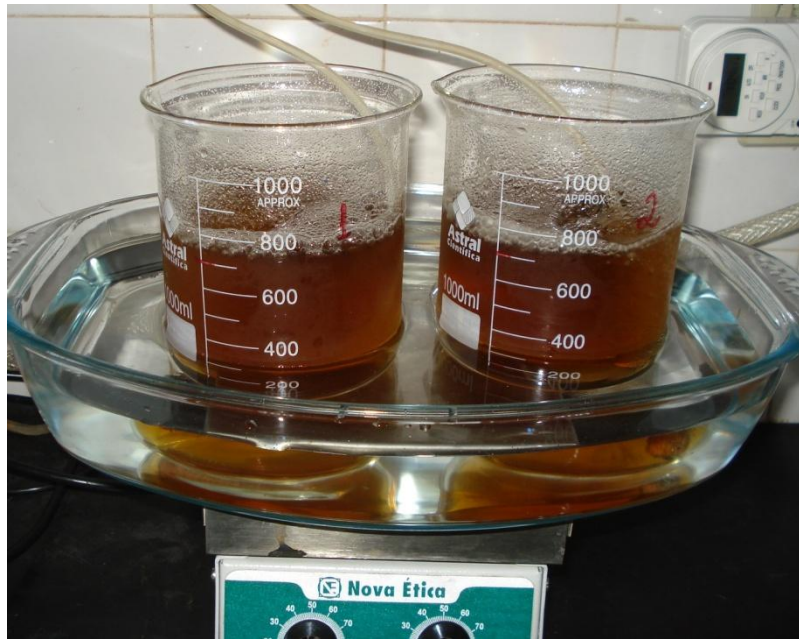
Figura 4: Visualização do tratamento biológico de bancada, constituído por dois reatores mantidos sob as mesmas condições.
