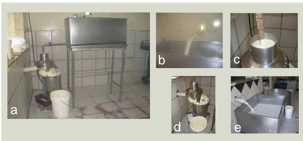
Figura 5.13- Processo de desnate do leite.
