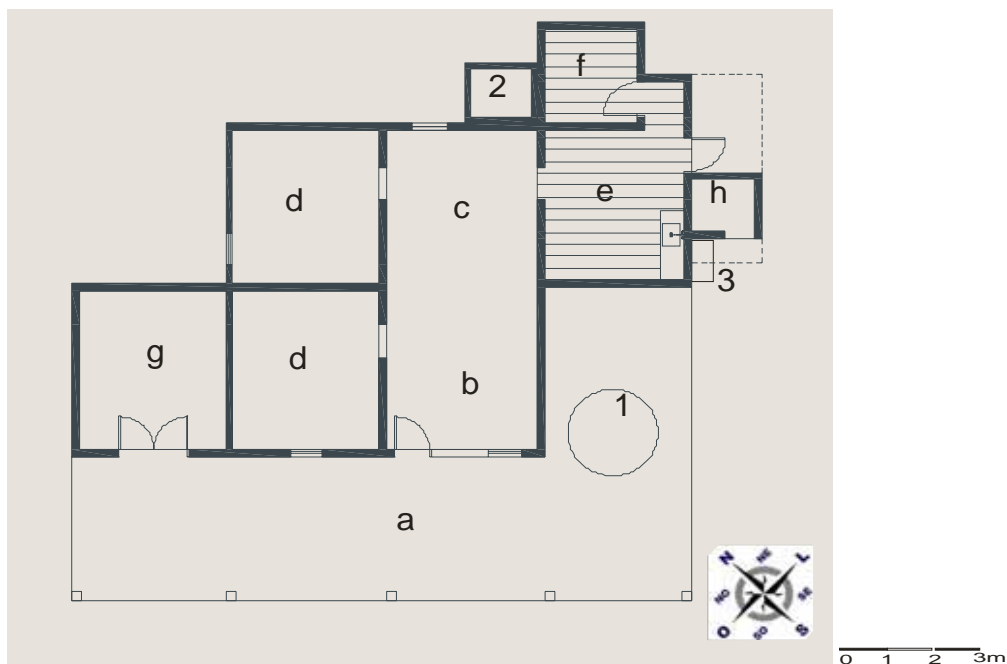
Figura 4.6 – Planta baixa da casa anexa à Fabriqueta 1.
