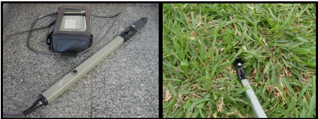
Figura 8 - Aparelho LAI-2000 utilizado para medição da IL e ângulo foliar
