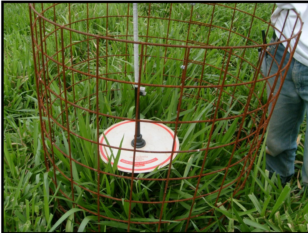
Figura 6 - Gaiola de exclusão utilizada para estimativa de massa de forragem
