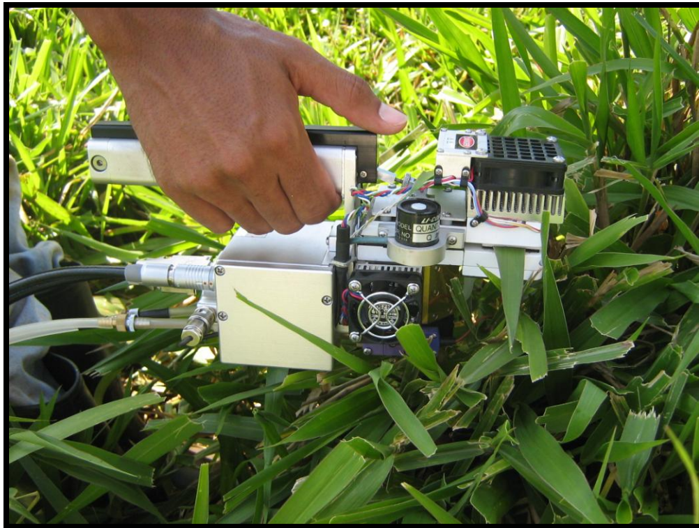
Figura 9 - C\u00e2mara de \text{CO}_2 do aparelho LAI-6400 utilizado para medi\u00e7\u00e3o da taxa de assimila\u00e7\u00e3o l\u00edquida de carbono
