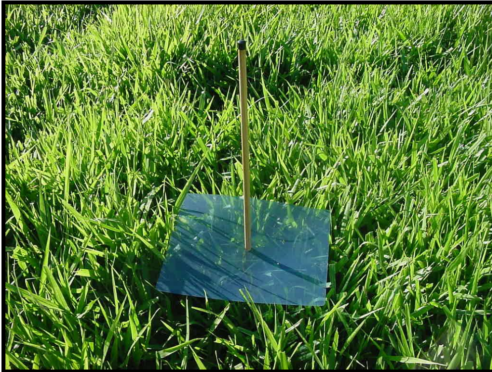
Figura 5 - Bastão graduado e uma folha de acetato utilizados para a medição de altura do dossel
