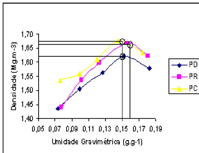
**FIGURA 18.** Curvas de compactação nos três diferentes preparos do solo (PD = plantio direto; PR = preparo reduzido e PC = preparo convencional), no Bloco V, com adubação mineral (AM) com rotação de culturas (R), na camada de 0-20 cm de profundidade.
