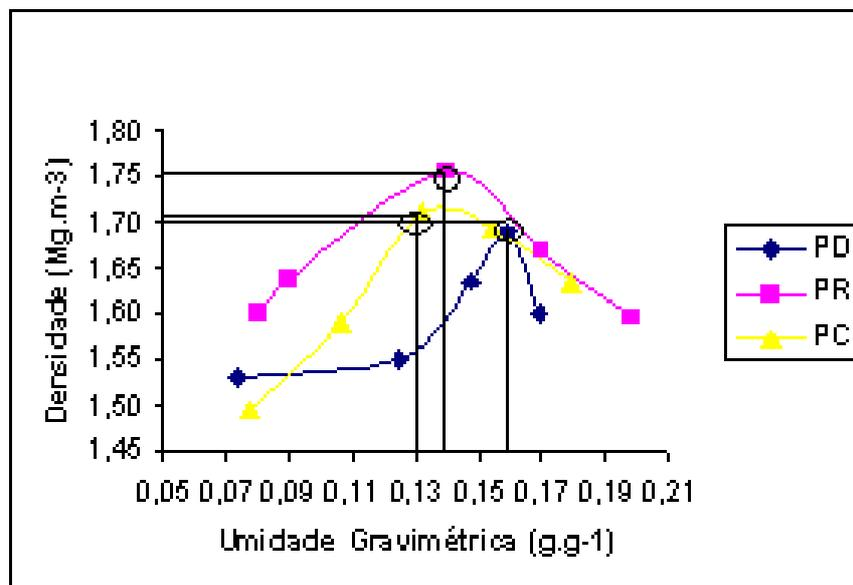
**FIGURA 14.** Curvas de compactação nos três diferentes preparos do solo (PD = plantio direto; PR = preparo reduzido e PC = preparo convencional), no Bloco I, com adubação mineral (AM), irrigado (I), com rotação de culturas (R), na camada de 0-20 cm de profundidade.
