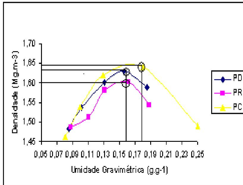
**FIGURA 17.** Curvas de compactação nos três diferentes preparos do solo (PD = plantio direto; PR = preparo reduzido e PC = preparo convencional), no Bloco IV, com adubação orgânica (AO) com sucessão de culturas (S), na camada de 0-20 cm de profundidade.
