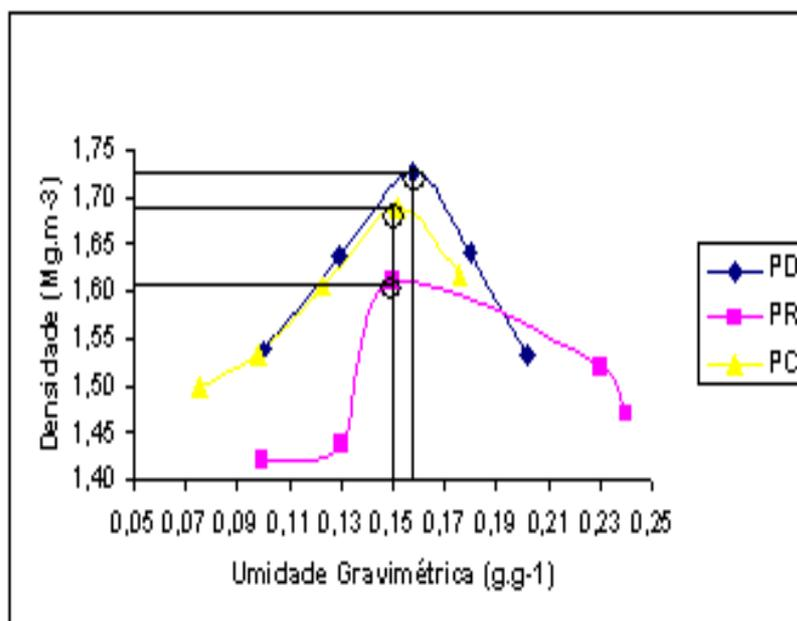
**FIGURA 19.** Curvas de compactação nos três diferentes preparos do solo (PD = plantio direto; PR = preparo reduzido e PC = preparo convencional), no Bloco VI, com adubação mineral (AM) com sucessão de culturas (S), na camada de 0-20 cm de profundidade.
