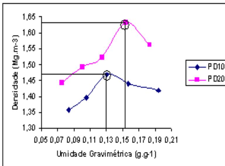
**FIGURA 26.** Curvas de compactação do solo em Plantio Direto na profundidade de 0 - 10 cm (PD10), comparada à do plantio direto na profundidade de 10 - 20 cm (PD20), no Bloco VIII, com adubação orgânica (AO), rotação de culturas (S).
