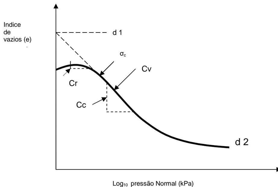
**FIGURA 2.** Curva característica de compressibilidade de um solo submetido a pressões crescentes (Lebert e Horn, 1991), onde d1 e d2 = densidade mínima e máxima; Cr = curva de recompressão;  $\sigma_p$  = pressão crítica; Cc = índice de compressão e Cv = reta virgem.
