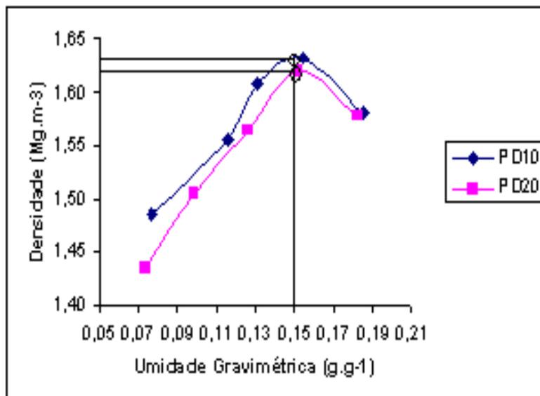
**FIGURA 24.** Curvas de compactação do solo em Plantio Direto na profundidade de 0 - 10 cm (PD10), comparada à do plantio direto na profundidade de 10 - 20 cm (PD20), no Bloco V com adubação mineral (AM) e com rotação de culturas (R).
