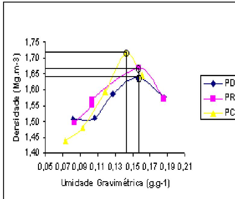
**FIGURA 15.** Curvas de compactação nos três diferentes preparos do solo (PD = plantio direto; PR = preparo reduzido e PC = preparo convencional), no Bloco II, com adubação mineral (AM), irrigado (I), com sucessão de culturas (S), na camada de 0-20 cm de profundidade.
