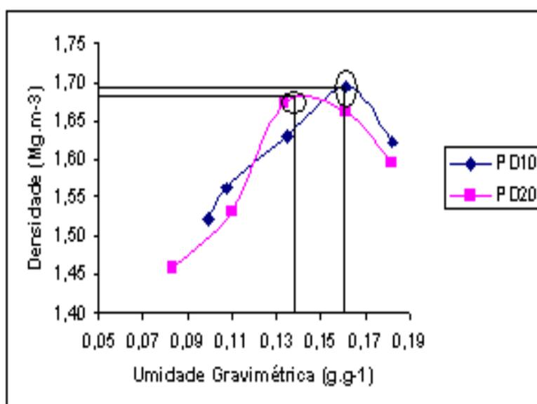
**FIGURA 23.** Curvas de compactação do solo em Plantio Direto na profundidade de 0 - 10 cm (PD10), comparada à do plantio direto na profundidade de 10 - 20 cm (PD20), no Bloco III com adubação mineral (AM) e Pousio (P).
