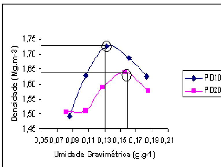
**FIGURA 22.** Curvas de compactação do solo em Plantio Direto na profundidade de 0 – 10 cm (PD10), comparada à do plantio direto na profundidade de 10 - 20 cm (PD20), no Bloco II, com adubação mineral (AM), irrigado (I) e com sucessão de culturas (S).
