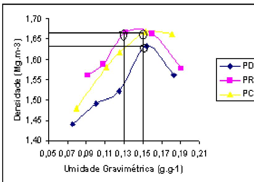
**FIGURA 20.** Curvas de compactação do solo nos três diferentes preparos do solo (PD = plantio direto; PR = preparo reduzido e PC = preparo convencional), no Bloco VIII, com adubação orgânica (AO) e rotação de culturas (R), na camada de 0-20 cm de profundidade.
