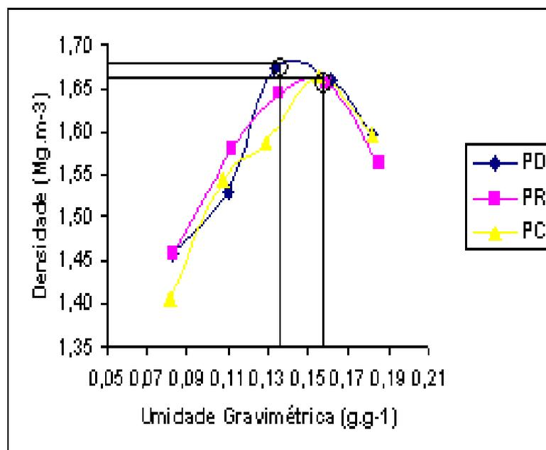
**FIGURA 16.** Curvas de compactação nos três diferentes preparos do solo (PD = plantio direto; PR = preparo reduzido e PC = preparo convencional), no Bloco III, com adubação mineral (AM) e pousio no inverno (P), na camada de 0-20 cm de profundidade.
