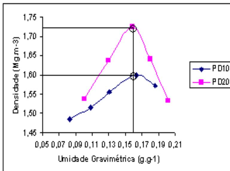
**FIGURA 25.** Curvas de compactação do solo em Plantio Direto na profundidade de 0 - 10 cm (PD10), comparada à do plantio direto na profundidade de 10 - 20 cm (PD20), no Bloco VI, com adubação mineral (AM) e com sucessão de culturas (S).
