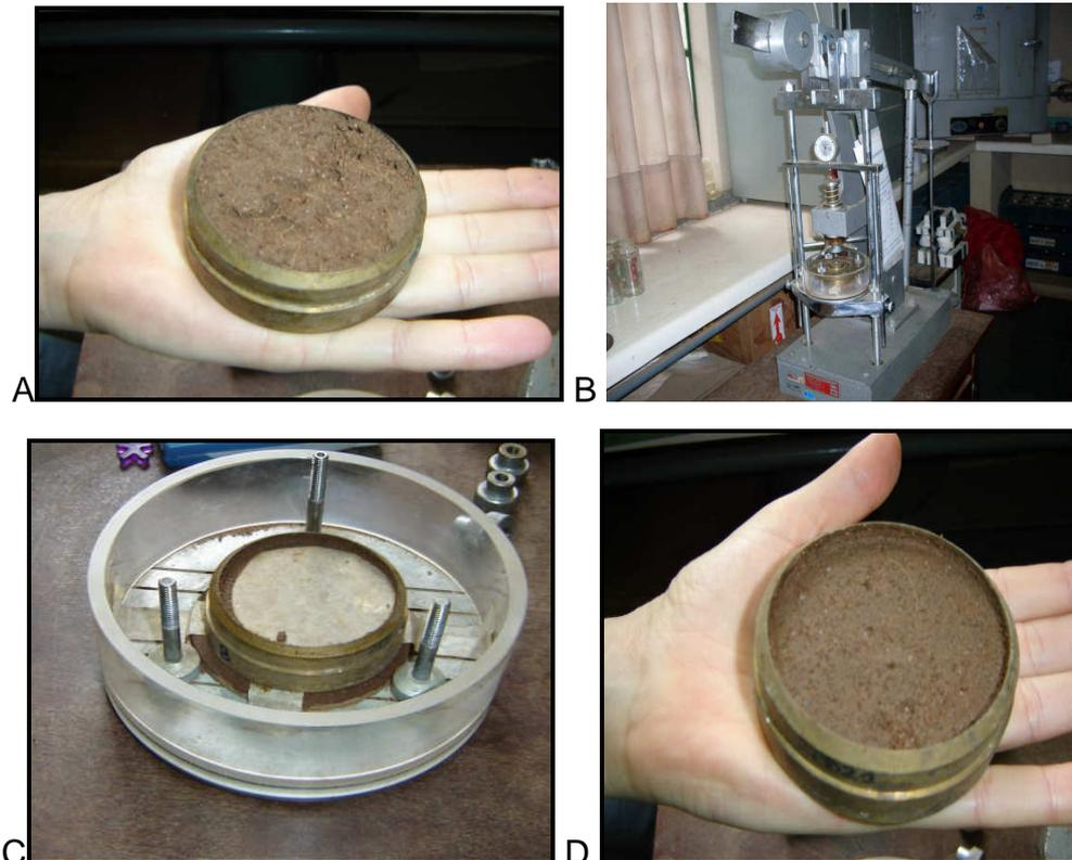
**FIGURA 6.** Determinação da compressibilidade do solo utilizando a prensa oedométrica. (A) Amostra no anel volumétrico antes de ser colocada na prensa; (B) Prensa Oedométrica Uniaxial; (C) Retirada da amostra da prensa; (D) Amostra prensada.
