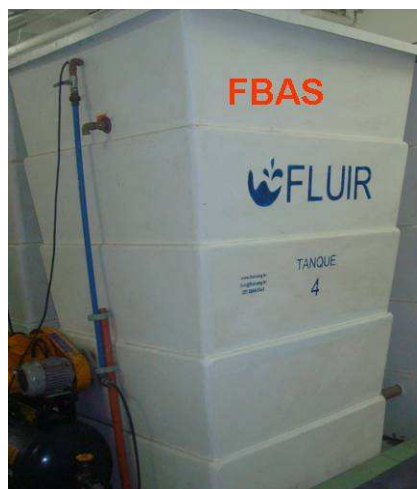
Figura 11: Filtro Biológico Aerado Submerso
