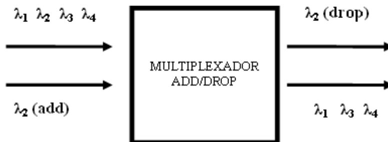
Figura 11: esquema de um multiplexador *add/drop* óptico
