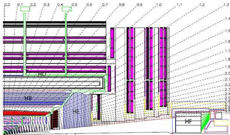
Figura 3.9: Vista longitudinal do detector CMS mostrando as localizações das seções do HCAL, HB, HE, HO e HF [32]
