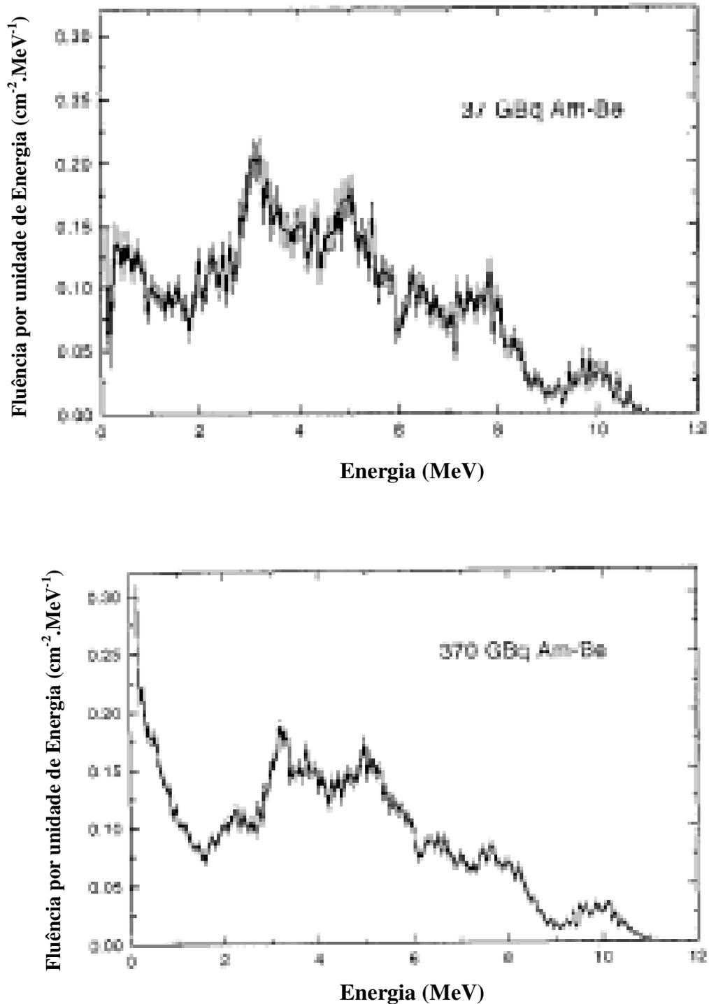
**Figura 5.27:** Espectro de Nêutrons de fontes de Am-Be com atividades distintas
