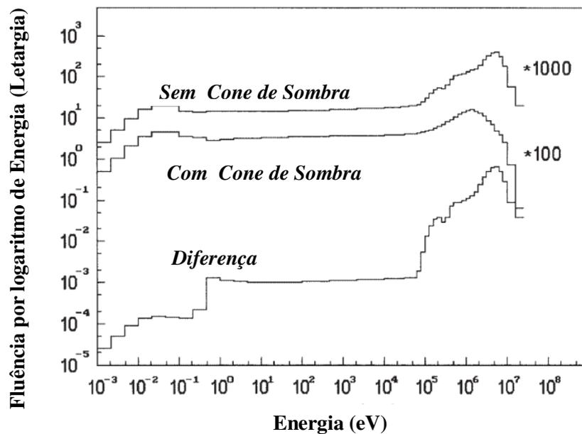
**Figura 4.2:** Espectros de Nêutrons da fonte de Am-Be [80]
