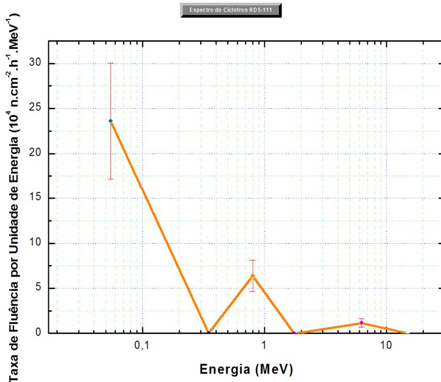
**Figura 5.15:** Deconvolução espectral do RDS-111
