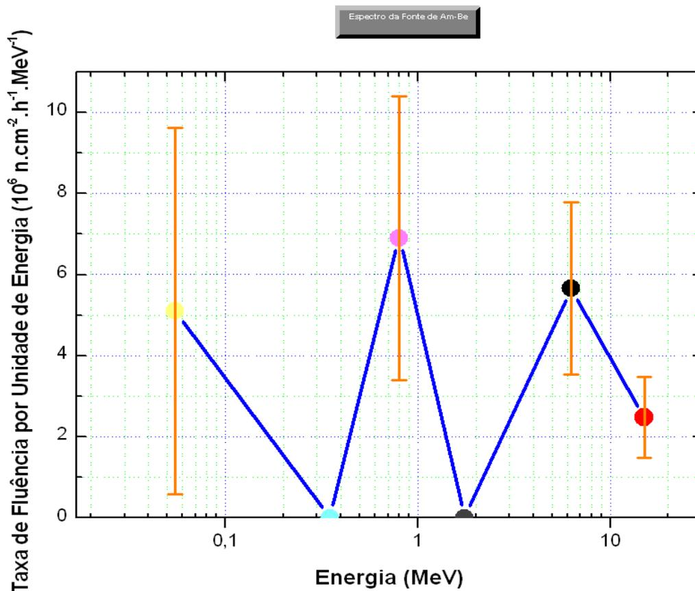
**Figura 5.12:** Deconvolução do espectro da fonte de Am-Be
