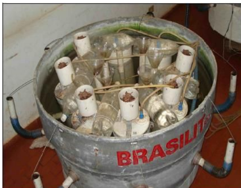
FIGURA 1. Biodigestores de bancada com volume útil de 10 litros cada
