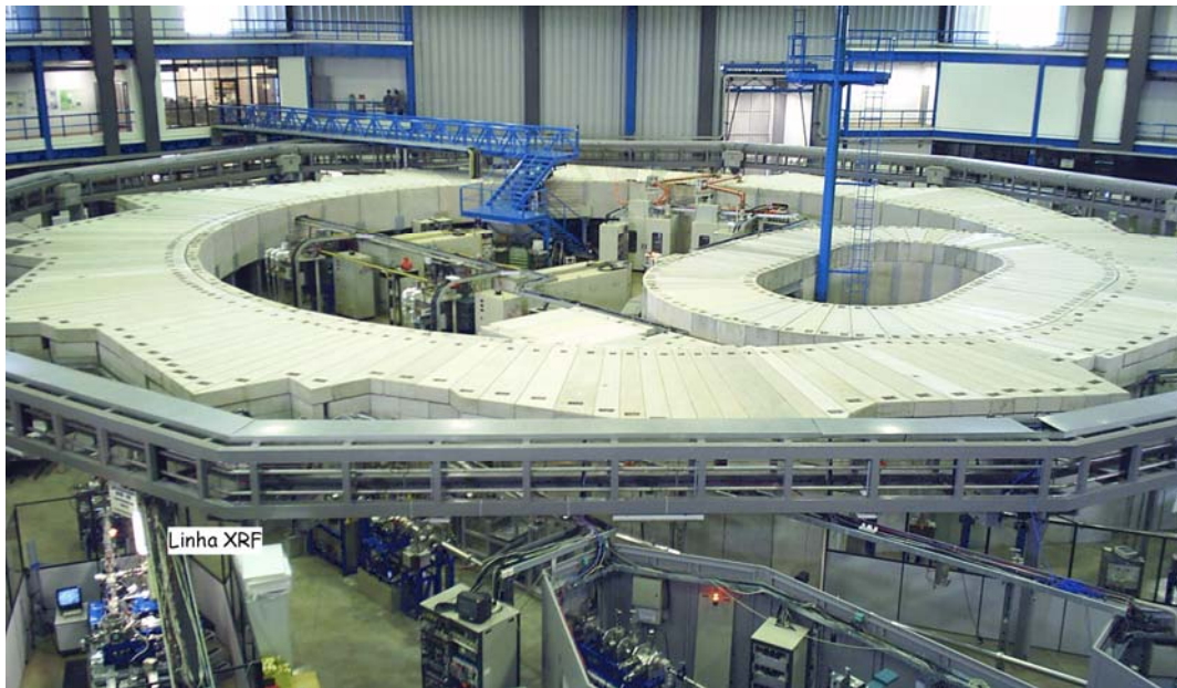
Figura 3.7 - Vista geral do anel de armazenamento de elétrons do LNLS e da linha XRF.
