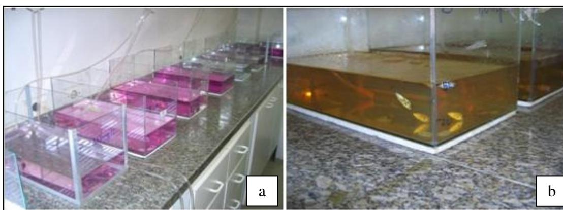
**Figura 9** - (a) Bateria de teste demonstrando a cor inicial do permanganato de potássio; (b) Cor do reagente após 24 h de exposição indicando sua oxidação no teste de toxicidade aguda com alevinos de tilápia, *Oreochromis niloticus*.
