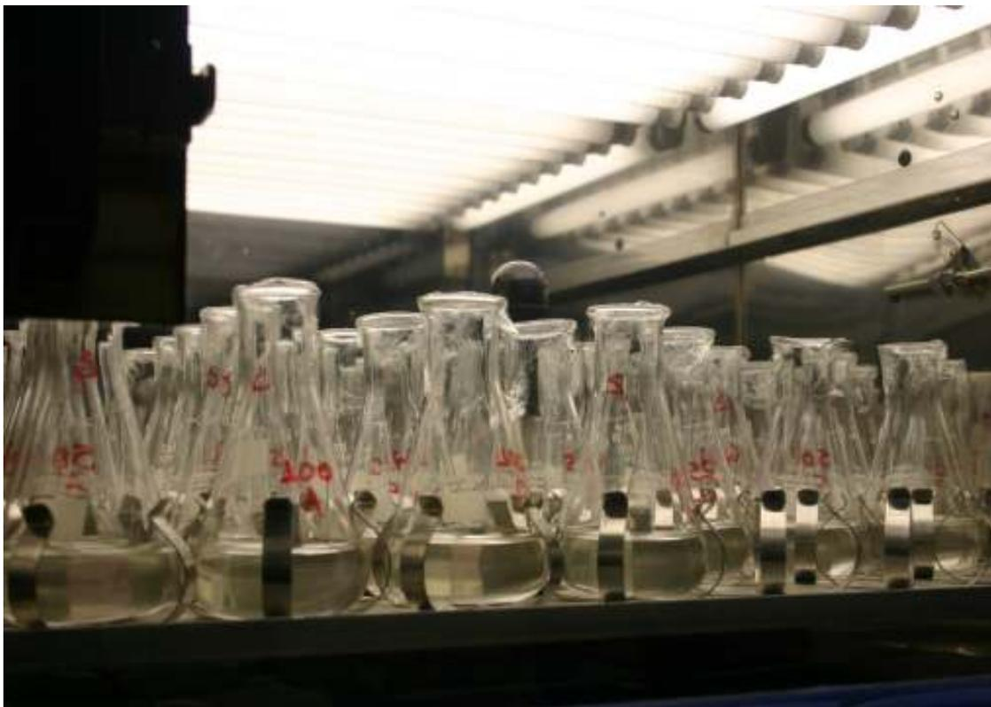
**Figura 6** - Vista interna da incubadora utilizada no experimento com a alga *P. subcapitata*
