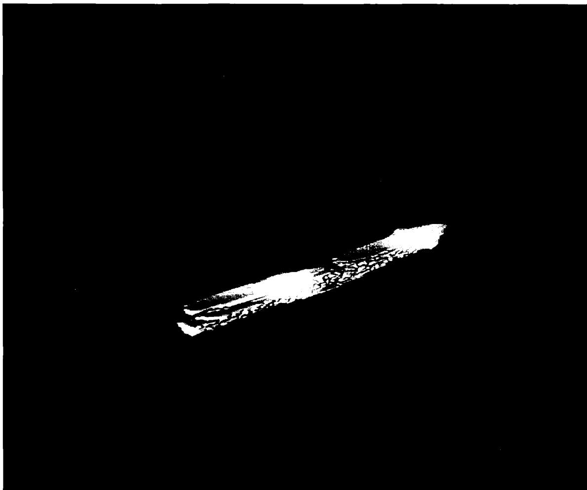
Figura 16: Imagem em perfil de relevo em três dimensões do volume do material ablacionado da amostra 3, reconstruída a partir das medidas por tomografia por coerência óptica.
