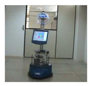
Figura 3.1: Robô SCITOS G5 no Laboratório de Robótica (LABOR/CENTAURO).
