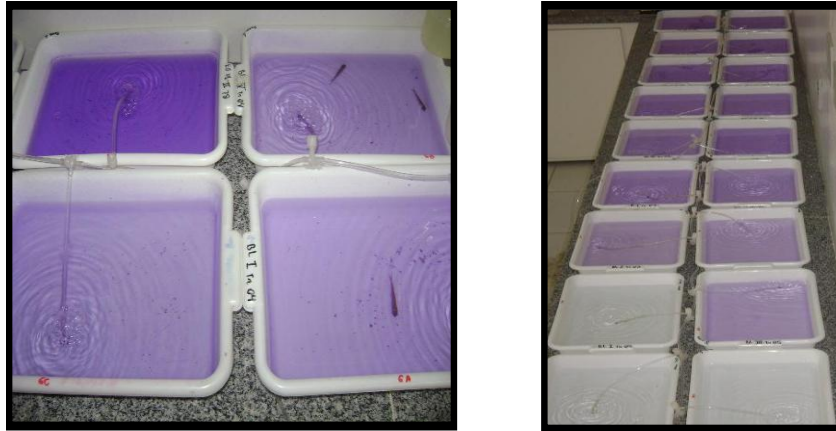
Figura 4- Bandejas retangulares utilizadas como unidades experimentais para a avaliação da toxicidade dos herbicidas atrazine e picloram para Ctenopharyngodon idella .
