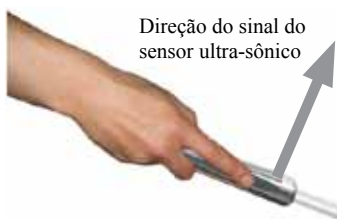
Figura 07: proposta/conceito da bengala longa eletrônica desenvolvida pelo pesquisador.
