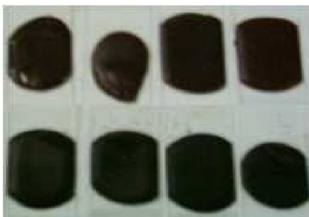
Figura 5.6: Tratamento térmico a 180 °C das amostras de SiO 2 ( 0 %, 3 %, 5 %, 10 %, 20 %, 30 %, 40 % e 50 % ).
