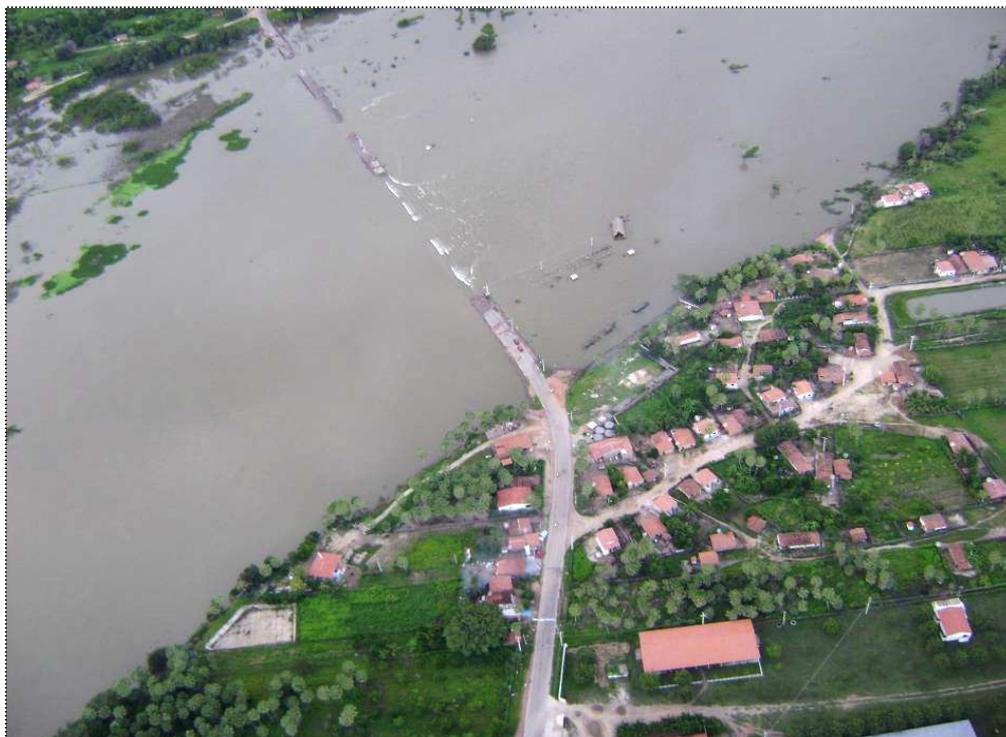
FIGURA 47 – Destruição de parte da estrutura da passagem molhada que liga os municípios de Tabuleiro do Norte e Limoeiro do Norte - CE.
