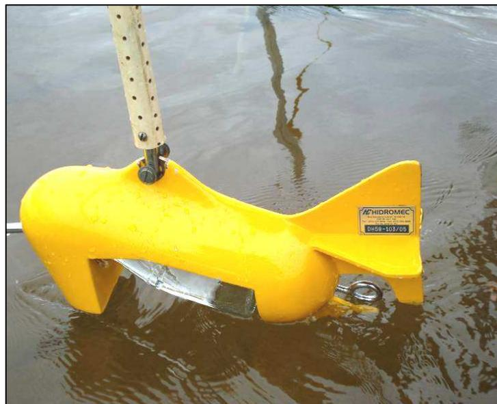
FIGURA 10 – Garrafa de integração vertical utilizada nas coletas de material em suspensão.
