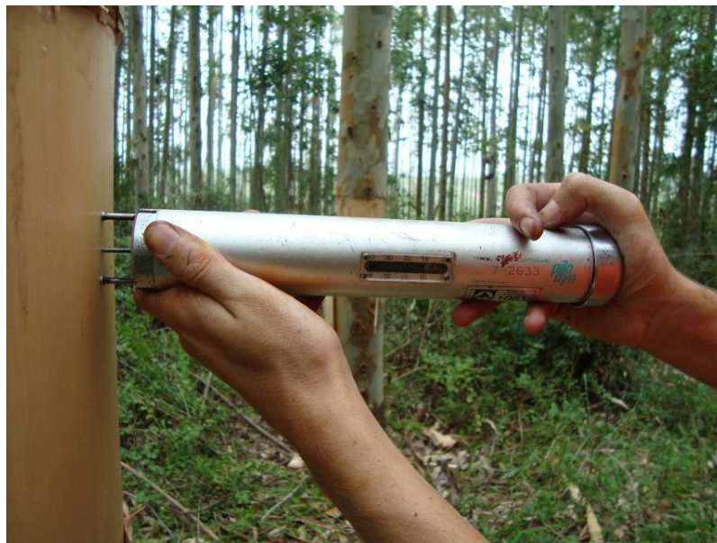
FIGURA 6 – Medição da densidade básica da árvore com o auxílio do Pilodyn.
