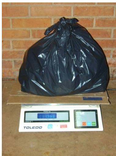
Figura 1 – Balança digital de bancada utilizada na aferição, em kg, dos resíduos gerados durante as três campanhas de pesagens realizadas no Hospital Veterinário Universitário.
