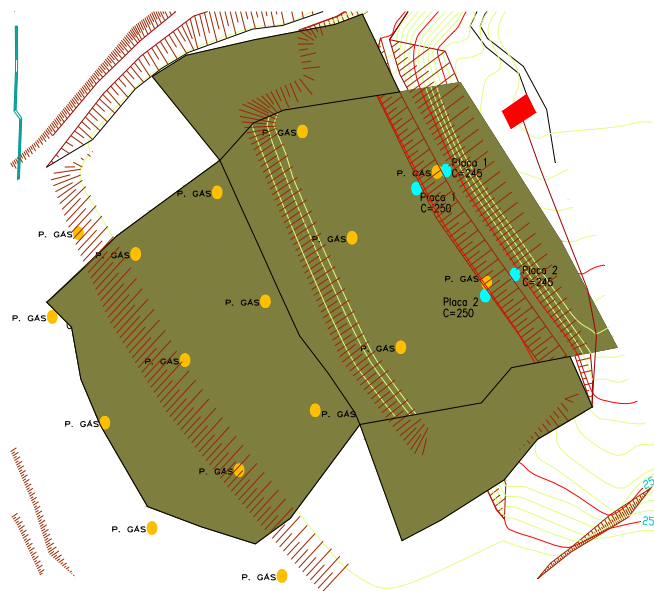
Figura 18: Distribuição dos drenos (pontos amarelos) no atual maciço de resíduos (Março 2009).
