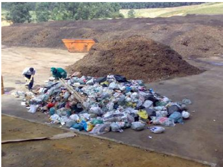
Figura 14 - Aspecto visual de uma amostra de RSU coletado no Vale do Aço, utilizada para avaliação da composição gravimétrica
