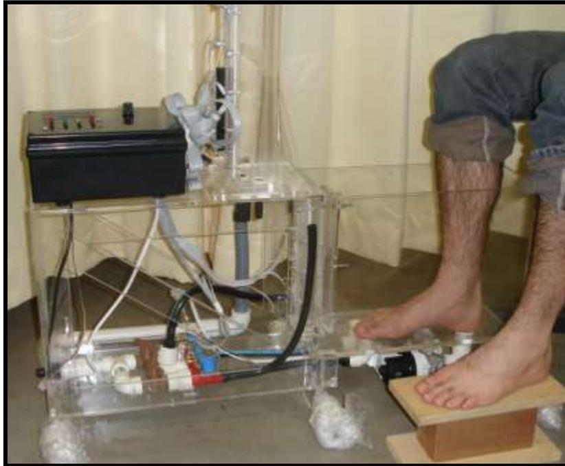
Figura 1 - Medida de volume com o hidropletismômetro
