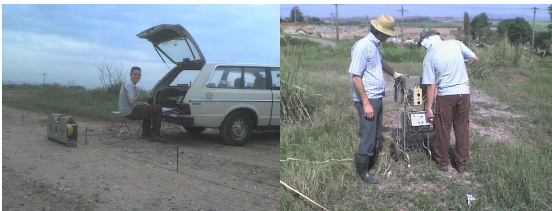
Figura 4.4: Coleta de dados com o resistivímetro BISON 2390. À esquerda: SEV 08. À direita: Linha 3.
