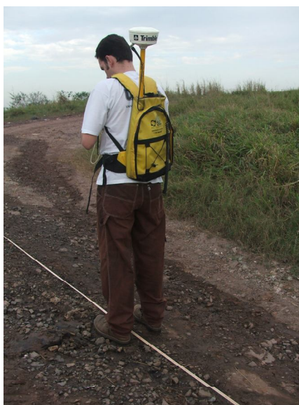
Figura 4.6: Coleta de dados com o GPS diferencial no aterro controlado de Rio Claro (SP).
