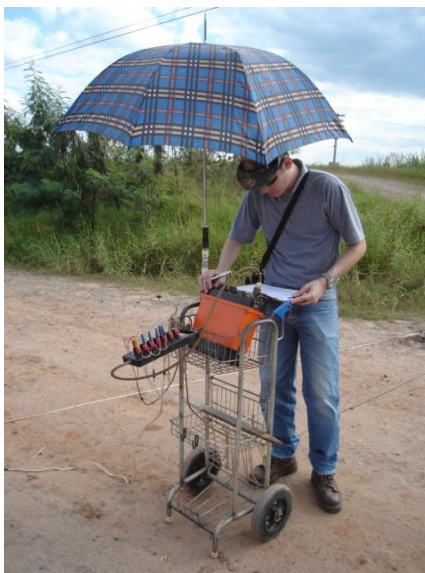
Figura 4.1: Coleta de dados da Linha 4-2 com o resistivímetro ABEM TERRAMETER SAS4000.
