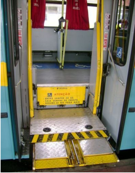
FIGURA 14 – ELEVADOR VEICULAR FONTE: FOTO FEITA PELO AUTOR
