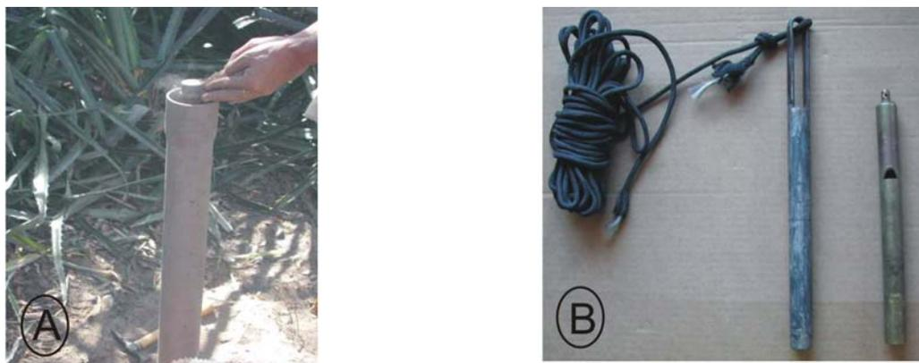
Figura 11 - A - Piezômetro. B - à esquerda coletor de água, à direita piu.
