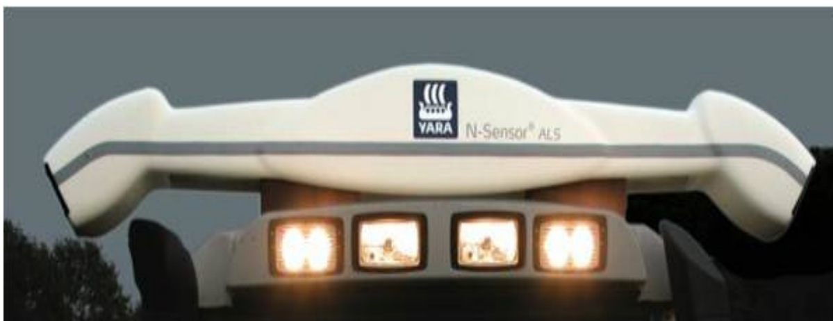
Figura 1 - N-Sensor ALS ® (YARA), sensor ótico ativo capaz de realizar a determinação da dose de N a ser aplicada a taxa variada em tempo real. Fonte: YARA, 2008.
