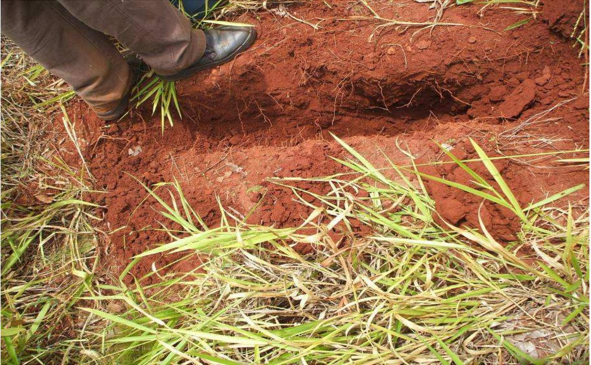
**Figura 15.** Trincheira aberta para a coleta de solo para análise química.
