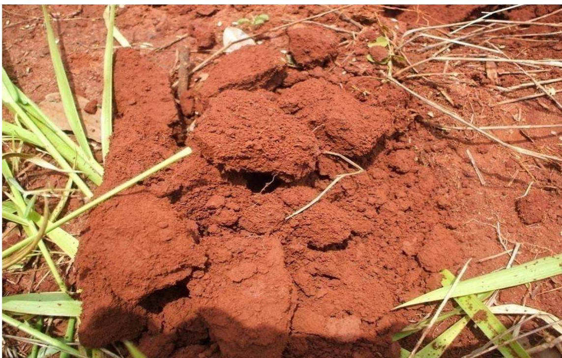
**Figura 14.** Torrão coletado para análise de estabilidade de agregados em água.
