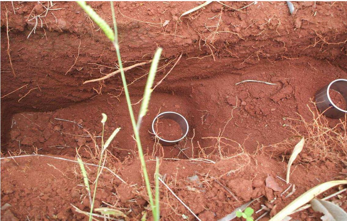
**Figura 13.** Coleta de amostra indeformada com anel volumétrico.
