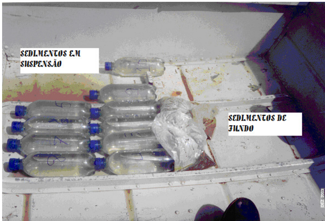
Figura 18 – Material coletado em campo, sedimento em suspensão e de fundo.
