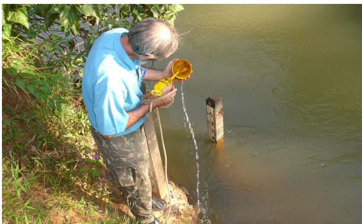
Figura 16 – Amostrador Rock-Island ou AMF2. Foto: Valmir J. Silva.
