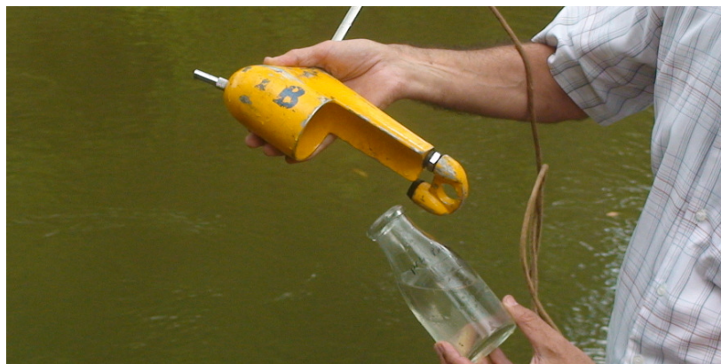
Figura 22 – Amostrador US.DH-48. Foto: Valmir J. Silva.
