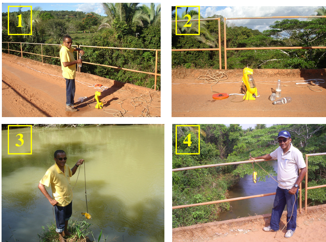
Figura 15 – Coletor USDH-59 (Fotos 1 e 2) utilizado em velocidades altas e coletor USDH-48 (Fotos 3 e 4) utilizado em velocidades baixas para coleta de sedimentos em suspensão. Foto: Pedro Rocha – UFMT.
