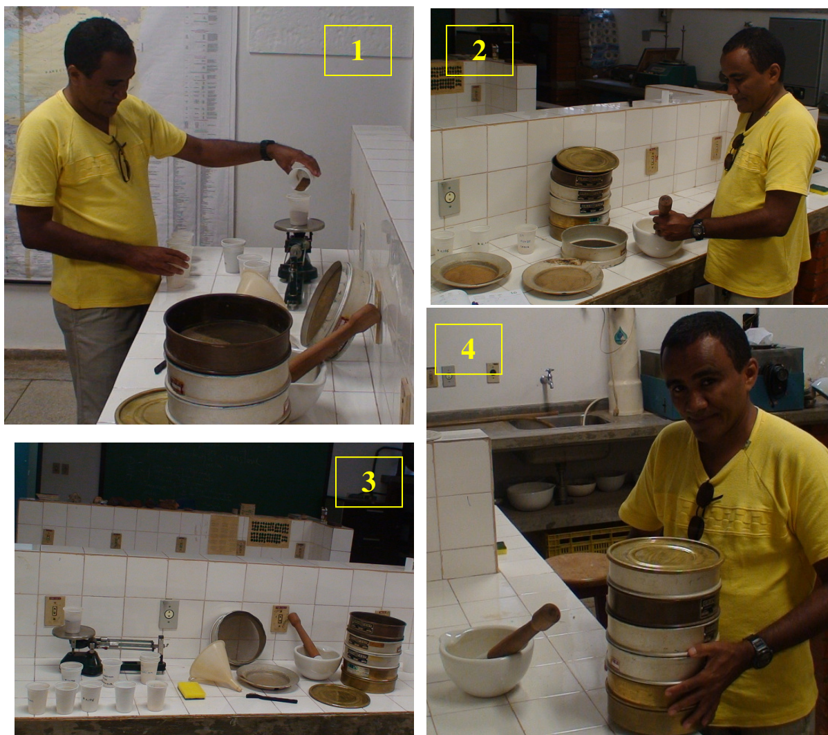
Figura 25 – Pesagem do sedimento (Foto 1), Destorroamento do sedimento em almofariz (Foto 2), Peneiramento (Foto 3), Vista da bancada do laboratório (Foto 4). Foto: Pedro Rocha. UFMT
