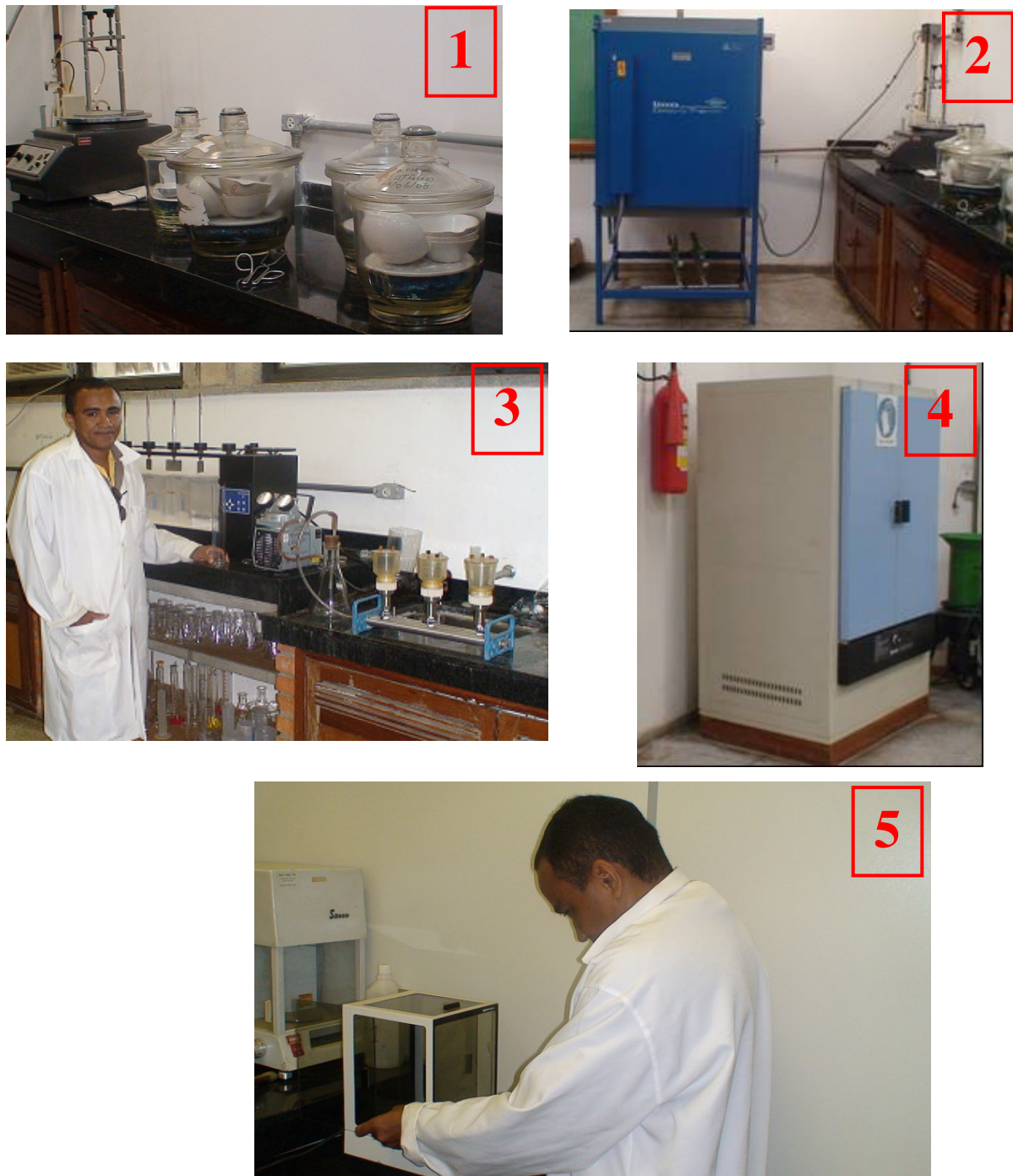
Figura 24 – Membranas em cápsulas de porcelana no dessecador (Foto 1), Mufla (Foto 2), Bomba a vácuo e conjunto de filtragem (Foto 3), Estufa (Foto 4), Balança Analítica (Foto 5). Foto: Pedro Rocha – UFMT.
